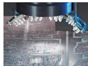
在许多生产过程中，产品检测是确保最终产品功能和可靠性的重要步骤。ETEL直驱直线电机以高精度和高产能广泛应用于自动光学检测（AOI）系统中。例如，在PCB检测设备中，目标线间距小于15微米，只有将高性能的光学系统与高性能的运动系统结合在一起才能满足高产能的要求。在IC基体检测中，必须控制仅几微米的结构，在芯片级或球栅阵列封装中，基体的结构通常属于该情况。
